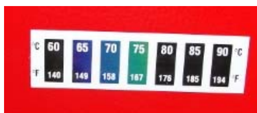
Фигура 5.6. Поглед към реверсивния (самовъзстановяващ се) термостикер за определяне на работната температура в зоната на горелката, в която е
