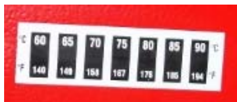
Фигура 5.4. Поглед към реверсивния (самовъзстановяващ се) термостикер за определяне на работната температура в зоната на горелката, в която е монтиран – състояние при стайна температура.
