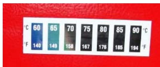
Фигура 5.5. Поглед към реверсивния (самовъзстановяващ се) термостикер за определяне на работната температура в зоната на горелката, в която е монтиран – състояние при повишена температура – в диапазона 60 – 65°C.
